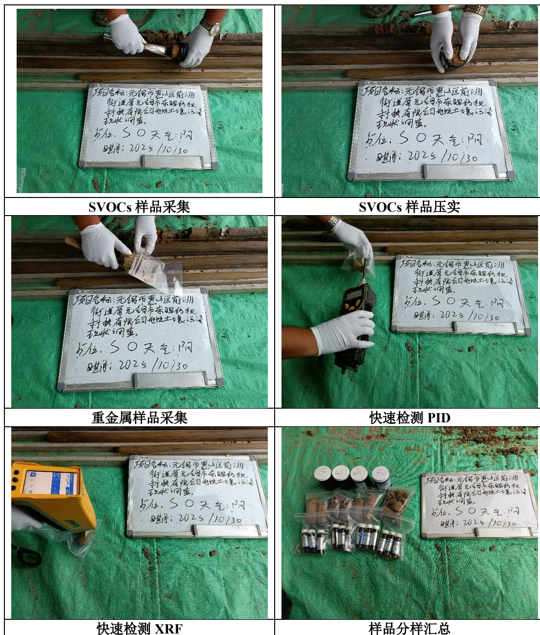
图 5.2-2 土壤样品取样与保存现场工作照片
